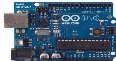
Fig-2: Arduino UNO
