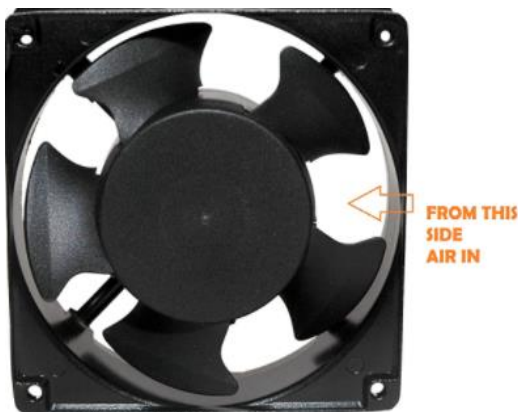
Fig: DC Exhaust Fan
