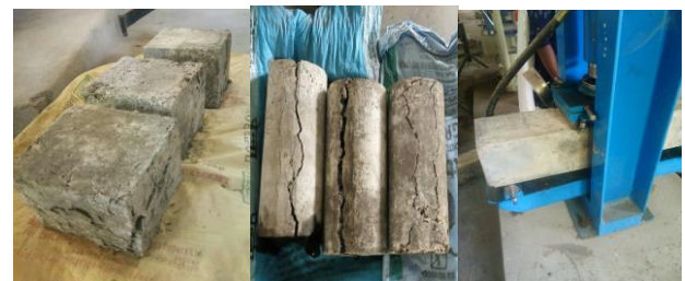
Fig-3 : Failure pattern
