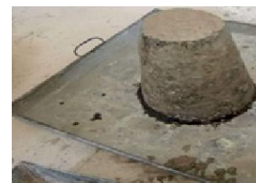
Fig: 1. Slump cone Test
