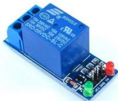
Fig 5: Relay module
