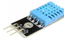
Fig 7: DHT11 sensor
