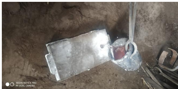
Fig: pouring the molten metal
