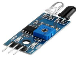
Fig -4: IR Sensor
