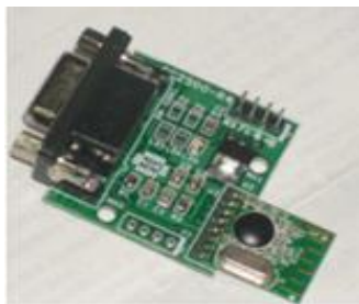
Fig.8. CC2500 RF Module
