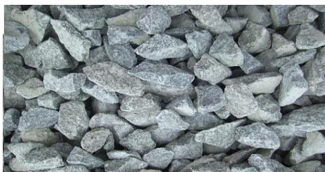
Fig. Coures Aggergate ( 20 mm)
