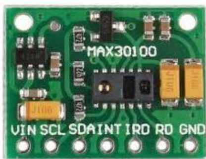
Fig -6: MAX30100 sensor module
