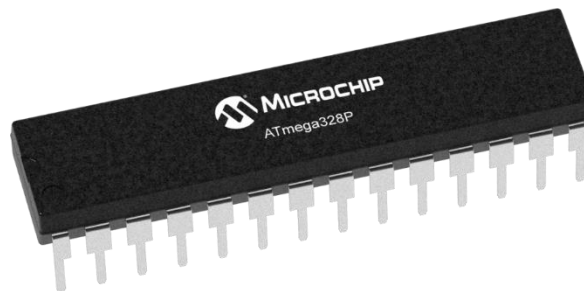
Fig: ATmega328P MICROCONTROLLER
