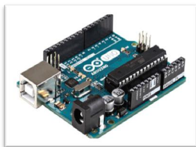
Fig 2.8: - Arduino Uno R3
