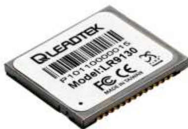
Fig -6: GPS module.
