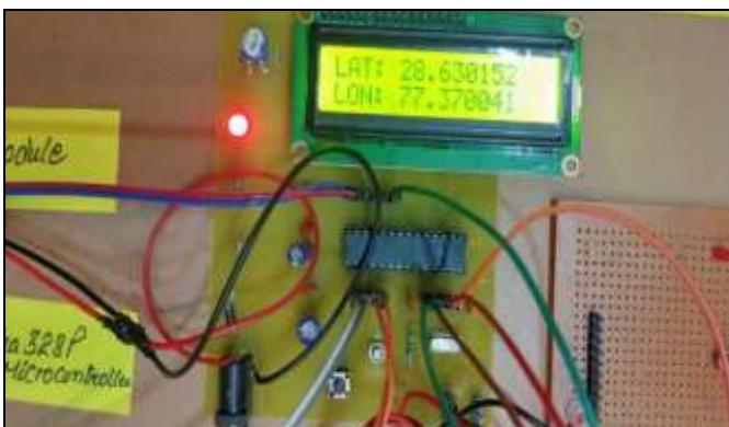
Fig -9: Output of latitude and longitude displayed on the LCD display screen
