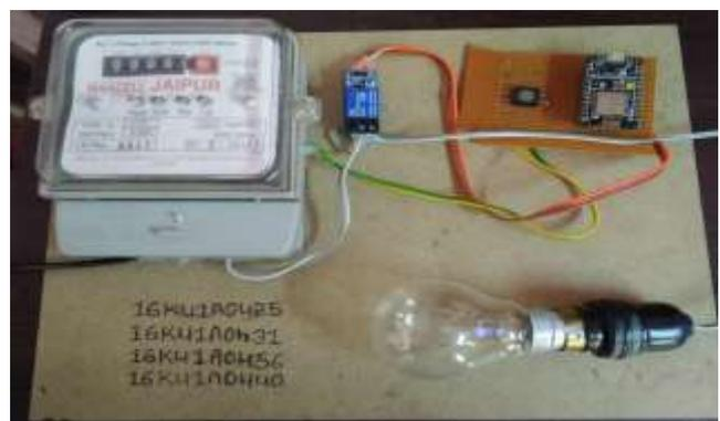
**Fig: 6** Prototype Of Electricity Energy Meter
