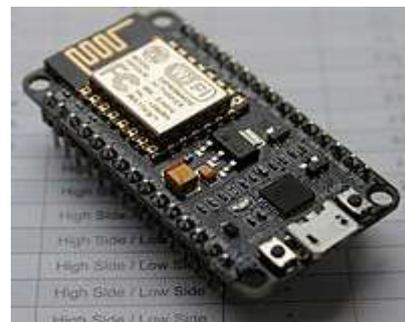
**Fig: 4** Node MCU ESP8266
