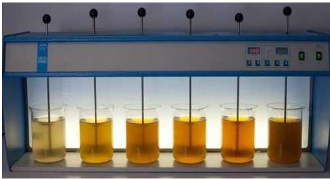
Fig - 4 : Jar test apparatus
