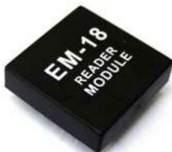
Fig 3: EM-18 Reader Module
