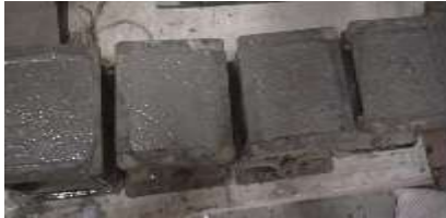
fig.no. 1 cube casting
