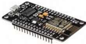
Fig-2: ESP8266 Wi-Fi Module
