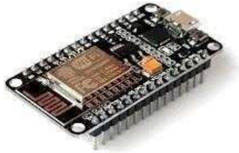
Fig -5: Microcontroller + Wi-Fi Module (Nodemcu ESP8266).
