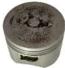
Fig -1 Actual photograph of Hero Honda CD Deluxe 100cc piston.
