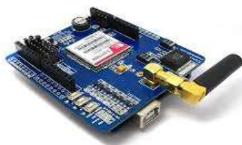
Fig-8: GSM and GPS MODULE
