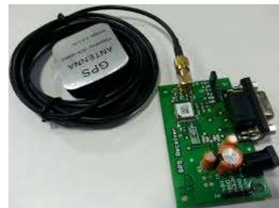
Fig -5: GPS Module
