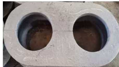
Fig No: 1 blow holes
