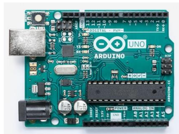
Figure 4 Arduino Uno R3
