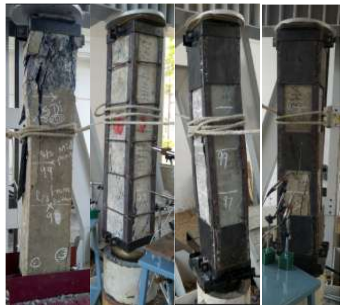
(a) (b) (c) (d) Fig -3: Failure Modes
