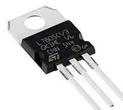
Fig.7. 7805 voltage regulating IC
