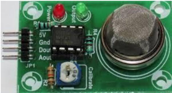
Fig. 7: MQ6 LPG GAS SENSOR
