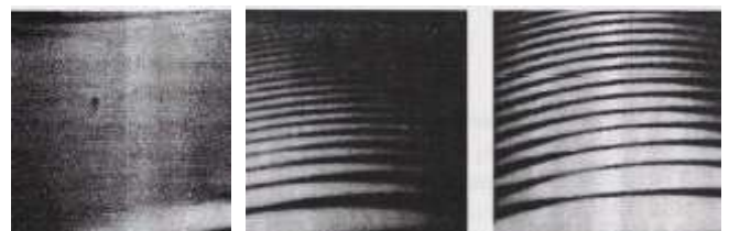
Fig. Scattering pattern of the ER fluid.
