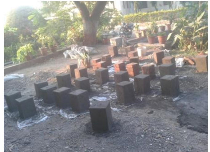
Fig 3). CURING OF COLUMNS
