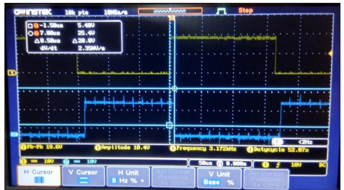
Figure 9 SIMPLE INVERTER GATE WAVEFORM
