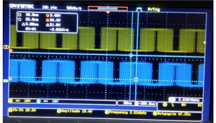
Figure 7 GATE PWM WAVEFORM
