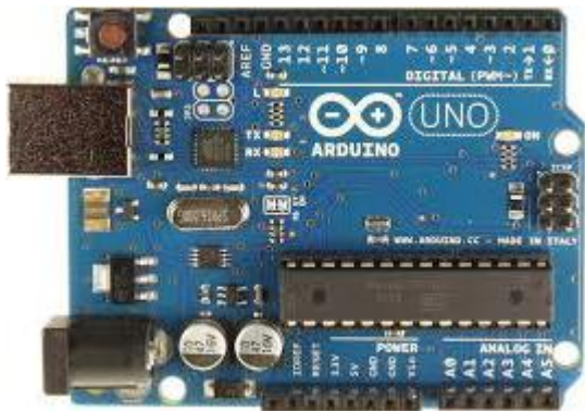
Fig-2: Arduino UNO
