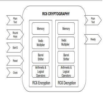
Figure 7. RC6 Block Diagram
