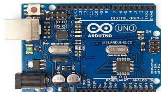
Fig-1: Arduino Uno
