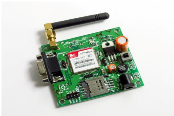
Fig-4: GSM modem using SIM900 module
