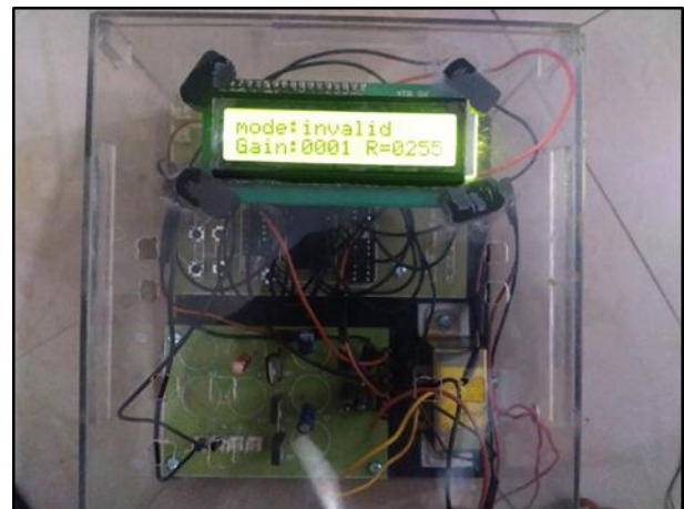
Fig -10: Actual circuit showing invalid mode (S7=1, S8=1)
