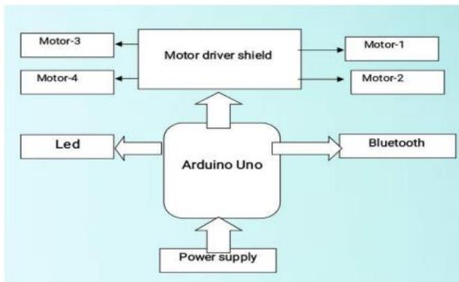
Fig-1: BLOCK DIAGRAM FOR REMOTE CONTROL TROLLEY
