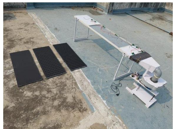
Fig -6: Actual Fabricated SAH Model
